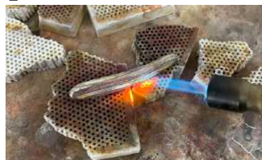
Laminar en perfil cuadrado el lingote de plata recociendo cada 3 pasadas
