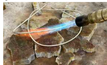
Llegar a 1,5mm de pie de metro Recocer antes de empezar a moldear
