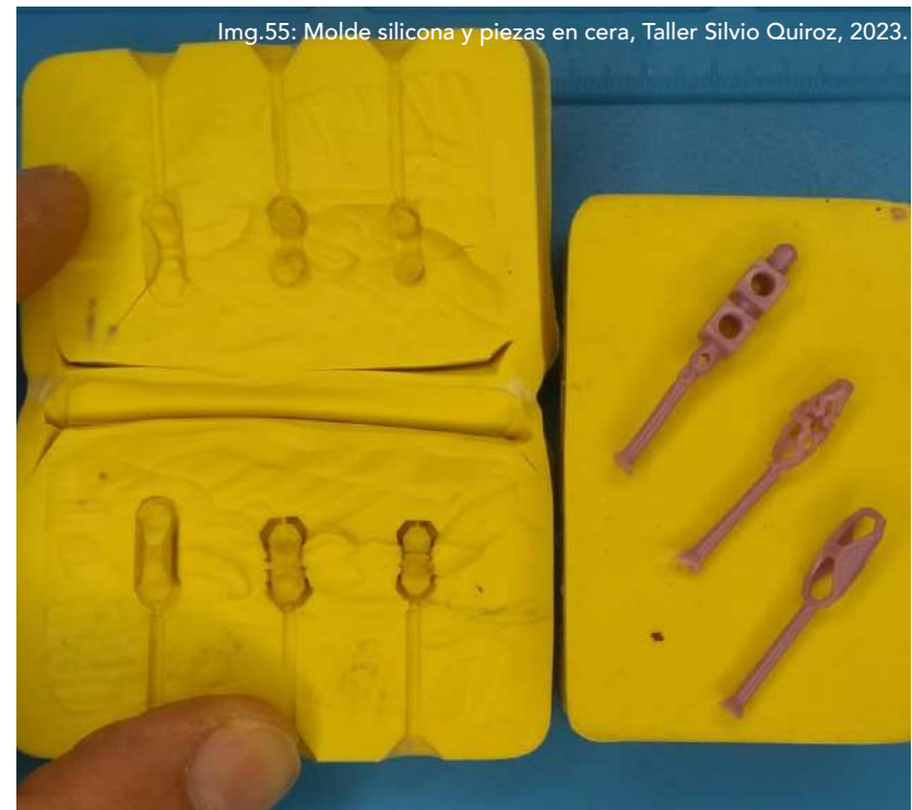
Img. 55: Este molde de silicona y sus respectivas piezas en cera se encontraban en el taller de Silvio, las cuales se utilizaron con el propósito de ejemplificar el proceso. Sin embargo, es importante destacar que en el proyecto final no se emplearon moldes para la creación de las piezas, ya que estas fueron elaboradas directamente en cera.
