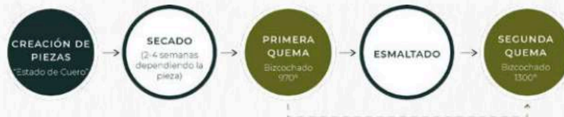
(Fig. 8. Esquema proceso de la cerámica gres, elaboración propia, en base a esquema en tesis Cuna)
