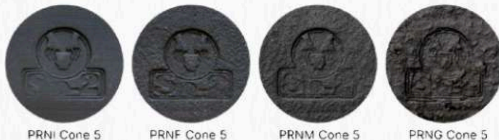
Efecto del chamote en la textura cerámicas (pasta negra cocida a 1200°C)
