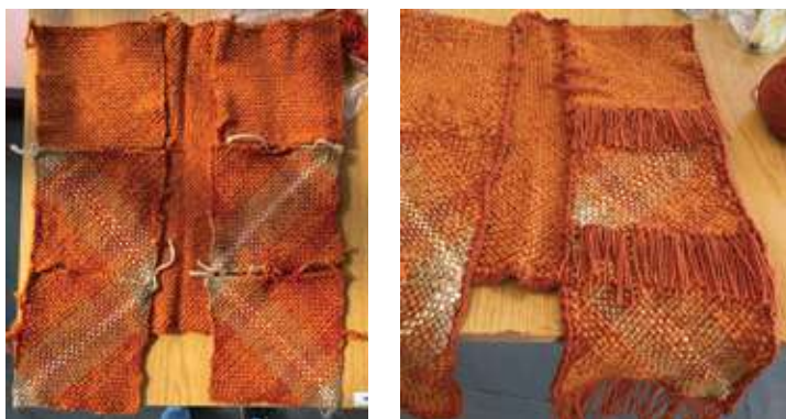
Se destacó la importancia del planchado previo a la unión para una mejor terminación de uniones
