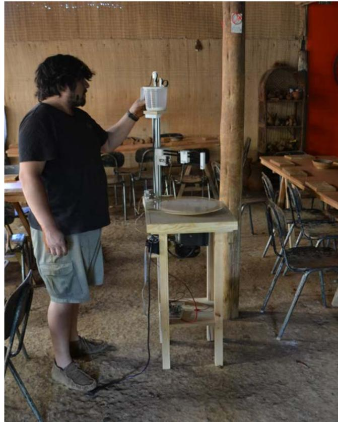
Posteriormente se conversó sobre el extrusor de greda, el cual no se pudo utilizar por problemas de presión y fuerza del motor stepper. Al respecto Edison se manifestó muy proactivo comentando diversas maneras de solucionar esta parte del sistema mecánicamente con tornillos o con un sistema de palanca. También se tocó el tema de los compresores, ya que uno de los alfareros del pueblo utiliza una máquina con un sistema hidráulico para grandes piezas de greda.
