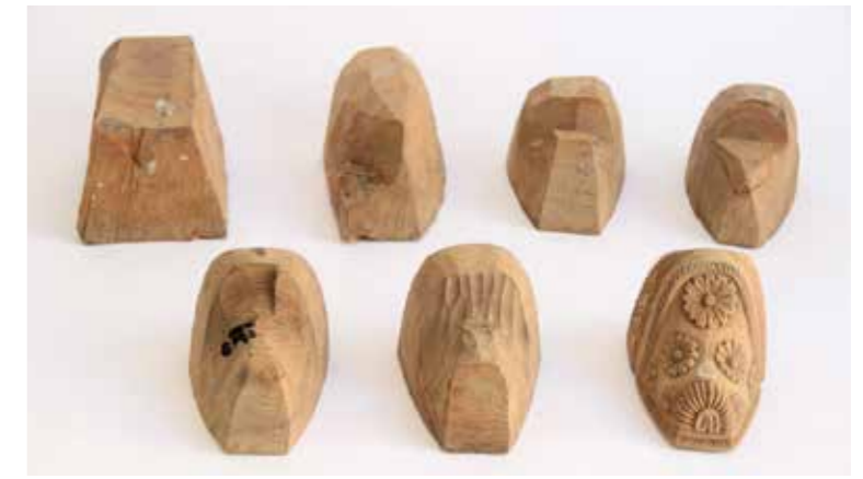
Proceso de fabricación de un estribo tradicional. El de la imagen corresponde al reconocido estribero fallecido, René Muñoz.
